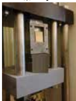
شکل ۱-۱۰ (پ)، نمونه در حال انجام آزمایش برش موازی الیاف
