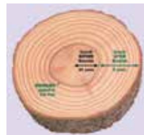
شکل ۱۴-۴- پهنای دایره سالیانه و نسبت چوب بهاره به تابستانه در چوب نراد
