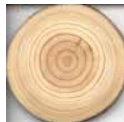
شکل ۱۳-۴- پهنای دایره سالیانه و نسبت چوب بهاره به تابستانه در چوب سرخ دار
