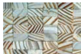
شکل ۳۲-۲ - نمای چوب لاریکس با چوب بهاره و تابستانه متفاوت
