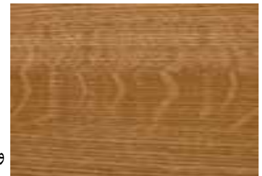
شکل ۱۴-۲- پر مگس در مقطع شعاعی چوب بلوط
