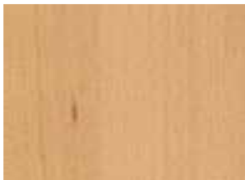
شکل ۲۵-۲- مقطع پره چوبی (چشمک) در برش مماسی در چوب راش
