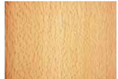
شکل ۱۳-۲- چشمک در مقطع مماسی چوب راش
