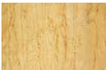
شکل ۱۹-۲- نقوش چشم بلبلی از آثار پیچیدگی الیاف چوب
