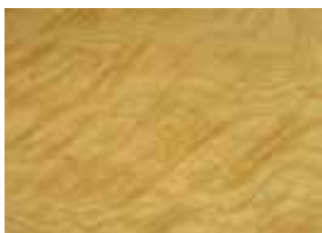
شکل ۱۸-۲- نقوش حاصل از پیچیدگی الیاف در چوب
