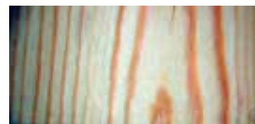
شکل ۳۱-۲ - نمای چوب کاج با چوب بهاره و تابستانه متفاوت
