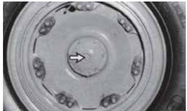
شکل ۸۹-۶ - تعویض روغن محفظه تازیر سوراخ
