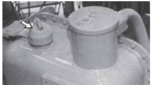
شکل ۹۱-۶ - پر کردن سیستم هیدرولیک فرمان از روغن
