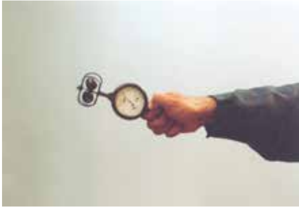
شکل ۸-۹ - طرز گرفتن هواسنج در مسیر جریان هوا
