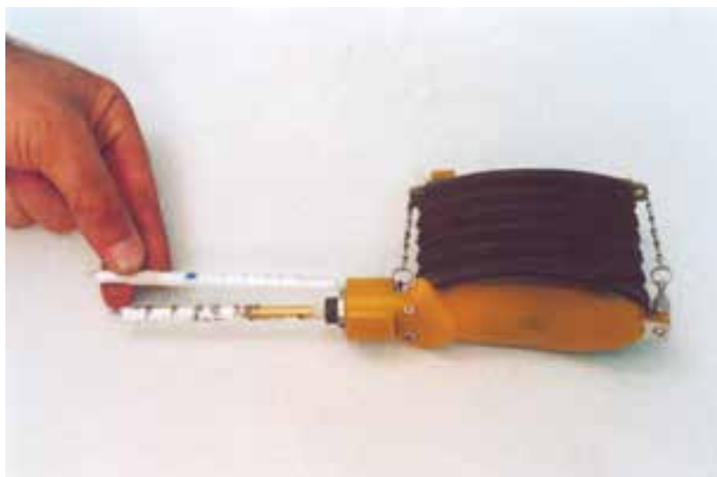
شکل ۱۶-۷ مقایسه تغییر رنگ کپسول مصرف شده با رنگ کپسول نو
