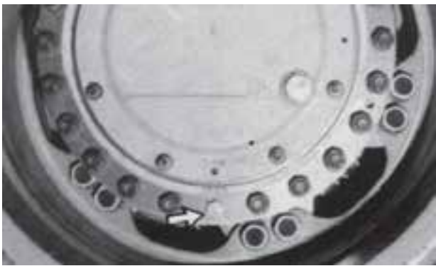
شکل ۸۸-۶- تعویض روغن چرخ‌ها
