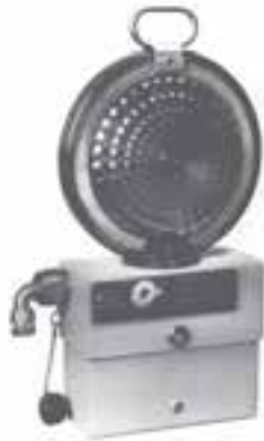
۳-۷- دستگاه اعلام خطر نصب به طور ثابت در محل های حساس معدن
