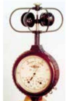
شکل ۱-۱-۸- آنومتر یا هواسنج فنجان‌ی
