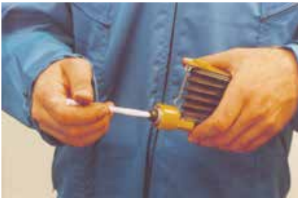
شکل ۱۳-۷- قرار دادن آمپول در داخل دستگاه ۱۴۳
