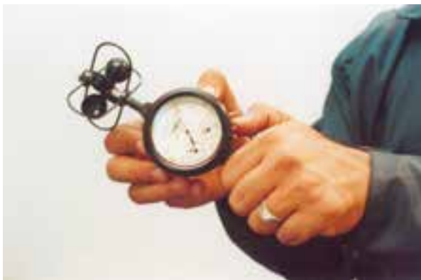
شکل ۸-۱۰ - قفل کردن عقربه توسط اهرم برای مدت یک دقیقه
