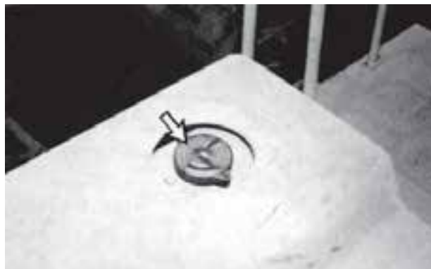
شکل ۹۵-۶ - قسمت شیر فشارشکن خنک‌کننده را تمیز کنید
