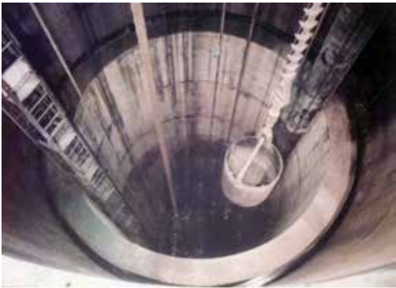
شکل ۶-۶- دهانه چاه اصلی در یک معدن
