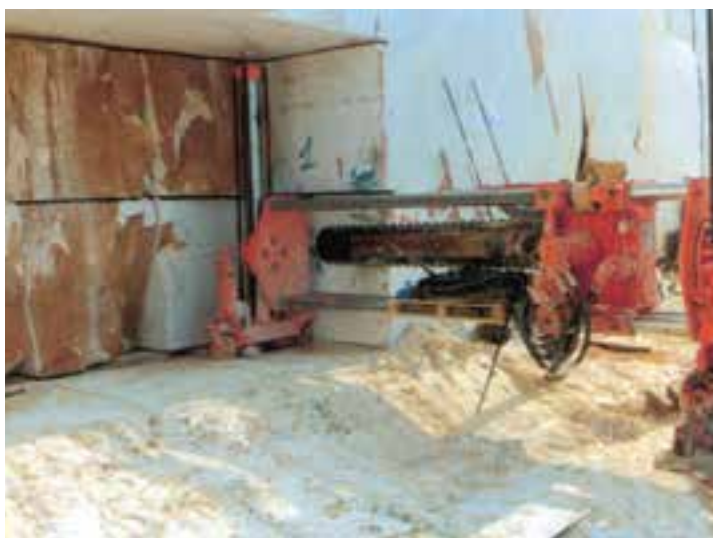
شکل ۱۵-۵- تیغه برنده در حین استخراج سنگ
