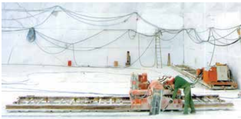
شکل ۱۶-۵- تیغه برنده در حالت برش قائم
