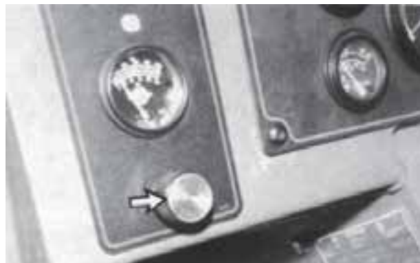
شکل ۴۴-۶- کنترل تمام چراغ‌های ماشین
