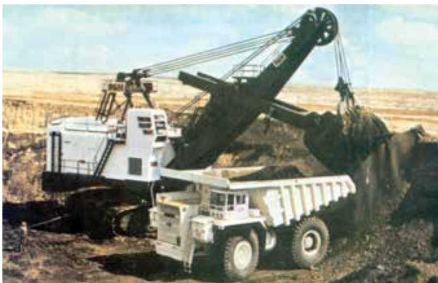
شکل ۲۴-۴- بیل کابلی در حال کار
