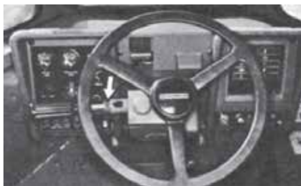
شکل ۲-۲۵-۴ — اهرم گیربکس (دسته دنده جهت تعویض دنده)
