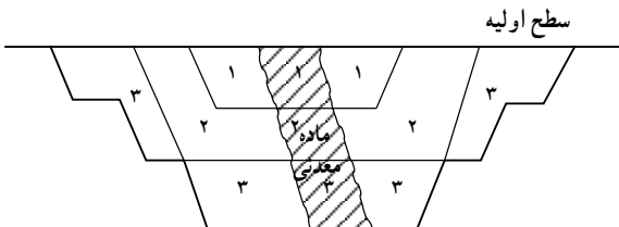
شکل ۱۴-۳- ترتیب استخراج پله ها و نمودار مربوط به روش صعودی
