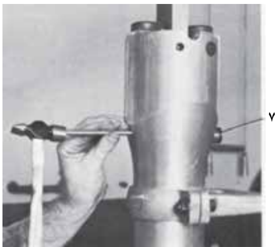
۱۳-۲- ز - بازکردن پیچ ۸ - گوه (۲) را از دستگاه بیرون آورده و تعویض کنید.
