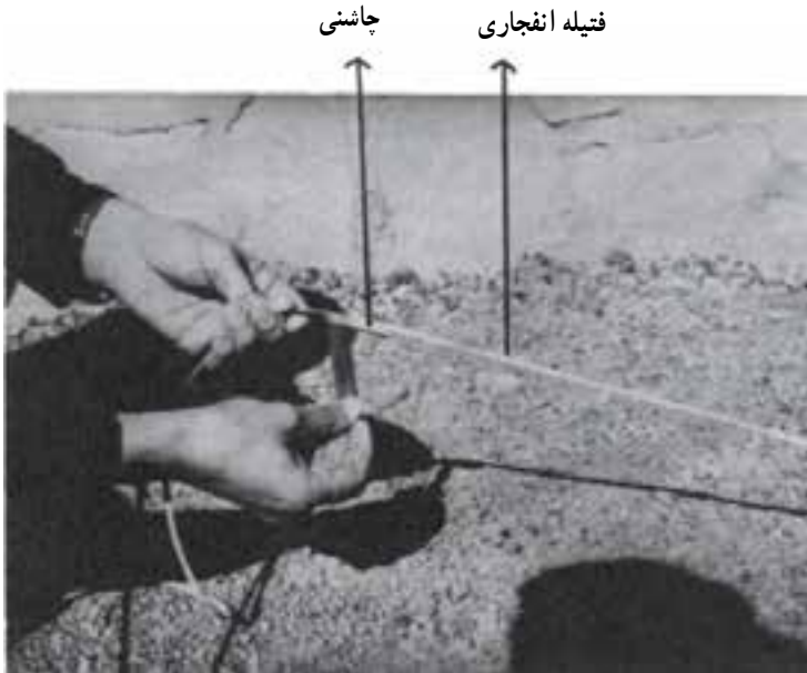
شکل ۱۷-۷- اتصال چاشنی معمولی به فتیله انفجاری با نوارچسب در اثر انفجار چاشنی، نصف فتیله منفجر خواهد شد.
