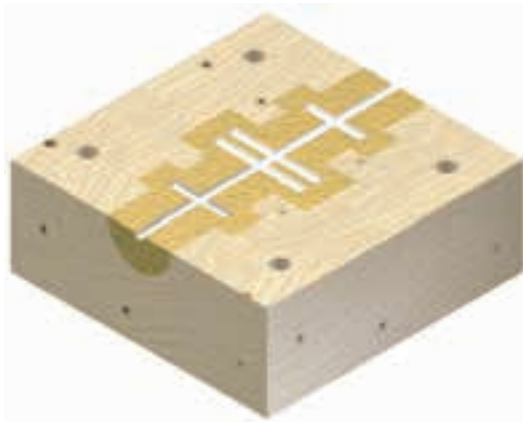
شکل ۱۴-۱۸ ایجاد مجرای خروج گاز با ابزار قاشقی
