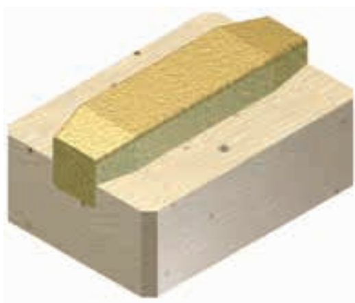
شکل ۲۳-۵ - قالب گیری ماهیچه (نیمی از ماهیچه)
