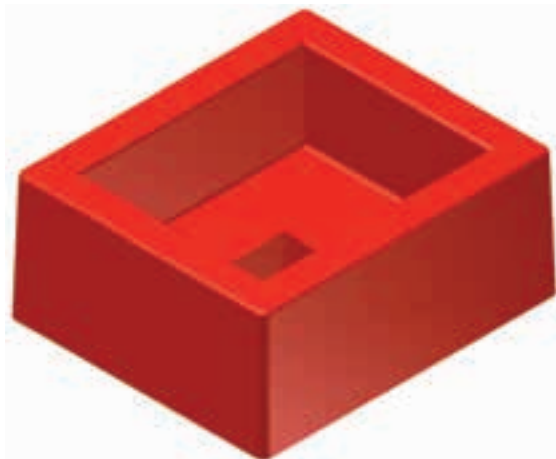
شکل ۷-۱- مدل با ماهیچه سرخود
