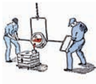
شکل ۸-۲۶ – بارریزی با کمچه و جرثقیل
