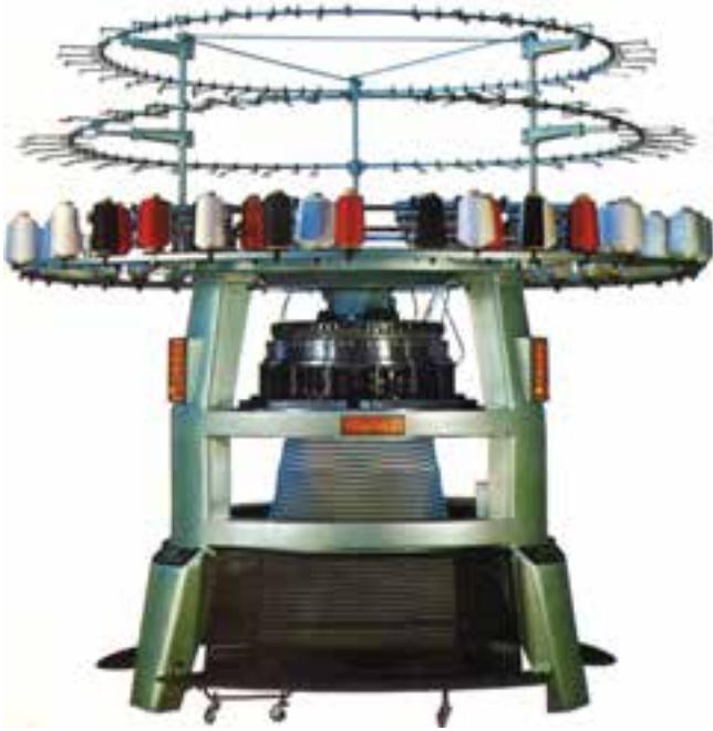
شکل ۲-۱۷- نمای یک ماشین گردباف مجهز به قفسه‌ی مدور نخ روی بدنه
