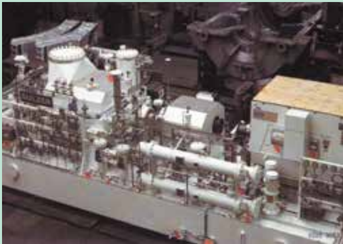
شکل ۷-۵-ج - کمپرسور استفاده شده در سیستم سردسازی
