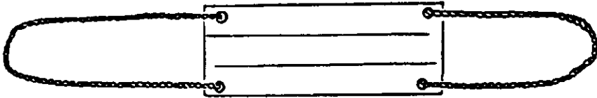
شکل ۸-۱۲- آویز تخته‌ای مخصوص حمل کالاهای شکستنی
