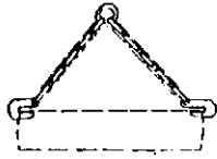
شکل ۱۳-۱۲- آویز زنجیری با قلاب‌های C شکل برای جابه‌جایی لوله
