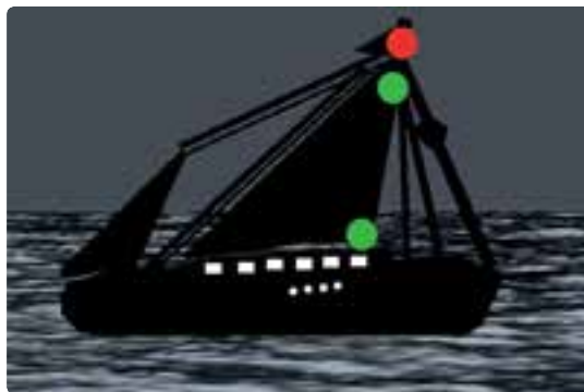
شکل ۱۱-۷- یگان شناور بادبانی در حال دریانوردی در شب با چراغ‌های دور تا دور (یا 36^\circ درجه) دکل (اختیاری)
