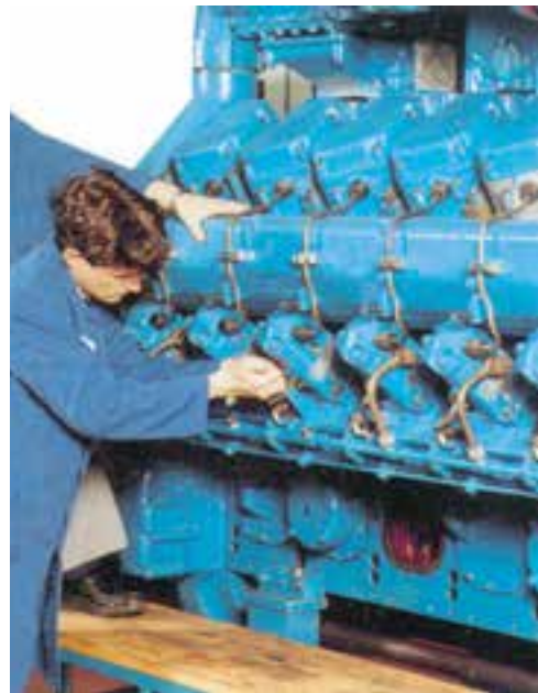
شکل ۱-۱۶- آماده کردن پمپ نفت افشان
