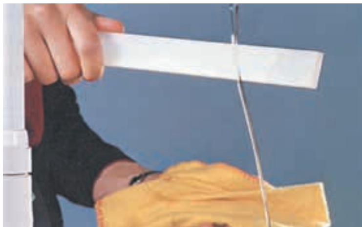
شکل ۱۰ باریکه‌ی آب با نزدیک شدن جسم باردار، از مسیر خود منحرف می‌شود.
