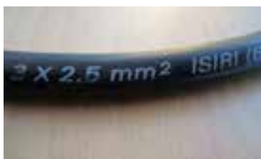
شکل ۲۷-۳ یک نمونه کابل NYY.
