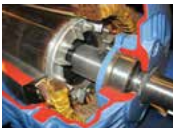
شکل ۴-۲۲ نماهای برش خورده موتور آسنکرون سه فاز.
