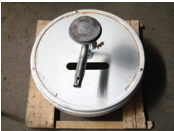
شکل ۱۱-۱۳- اجاق (کوره) آب گرم کن سرویس (تمیز) شده
