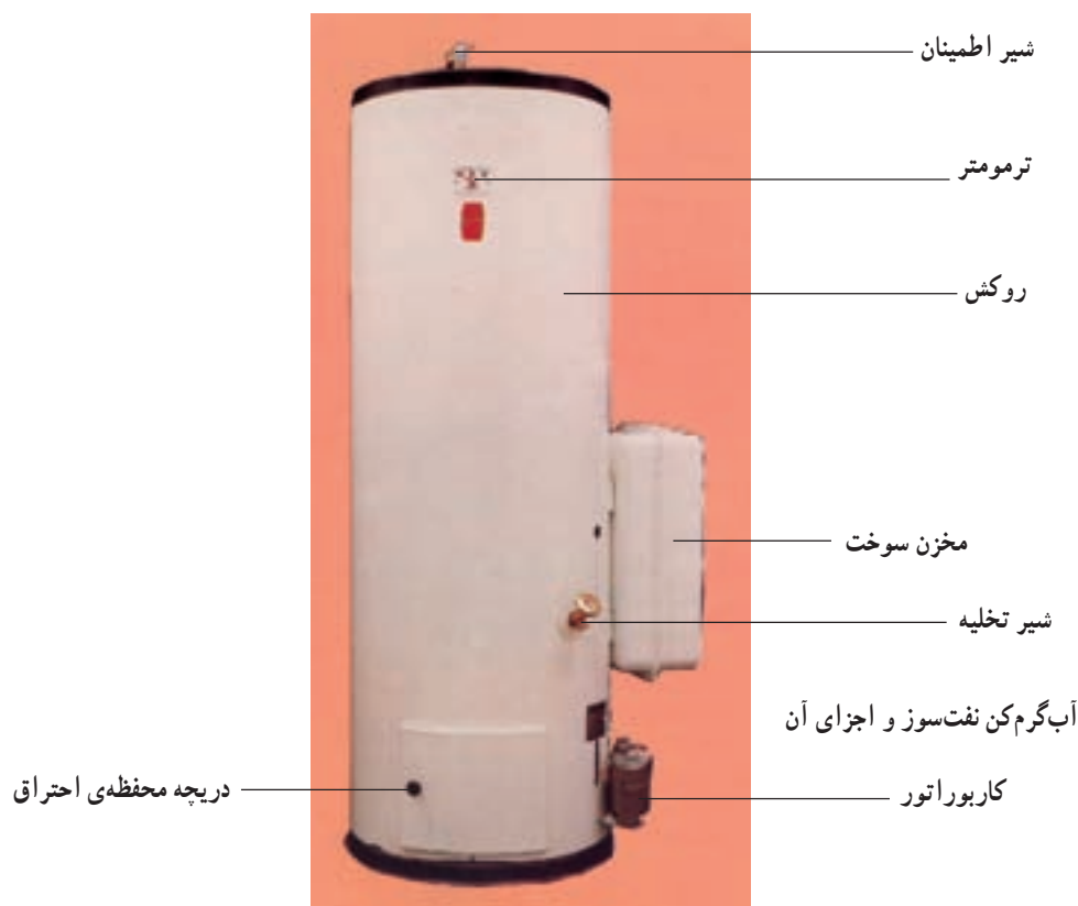
شکل ۱-۱۳- اجزای آب گرم کن نفت سوز
