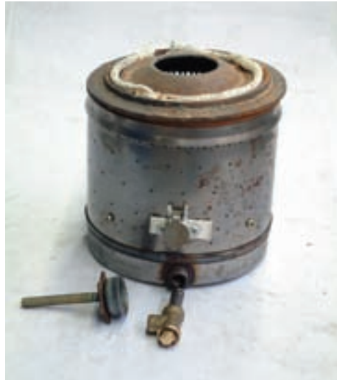
شکل ۲-۱۳- کوره آب‌گرم‌کن نفت‌سوز
