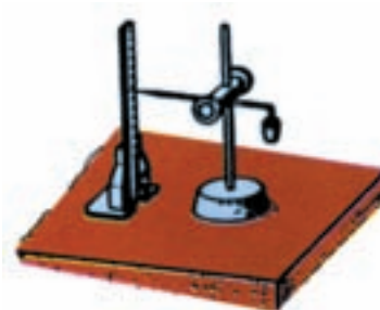
شکل ۳-۶- تنظیم ارتفاع سوزن
