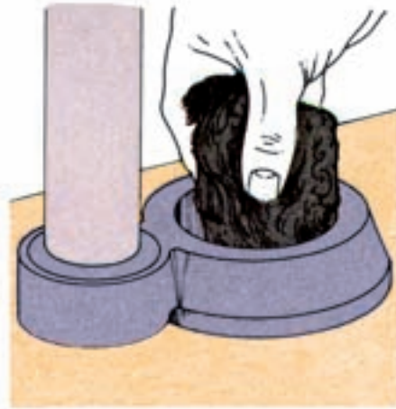
شکل ۵۲-۱۰- رسوب‌زدایی نشیمنگاه زیراب
