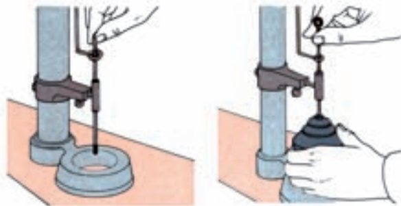
شکل ۵۳-۱۰- تنظیم لاستیک مخروطی بر نشیمنگاه زیراب
