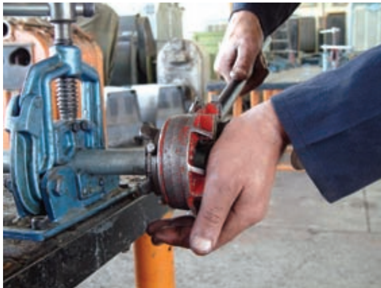
شکل ۱-۴۱- شروع حدیده کاری
