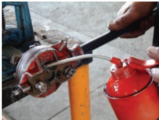
شکل ۱-۴۲ - ریختن روغن برای روانکاری و خنک‌کاری
