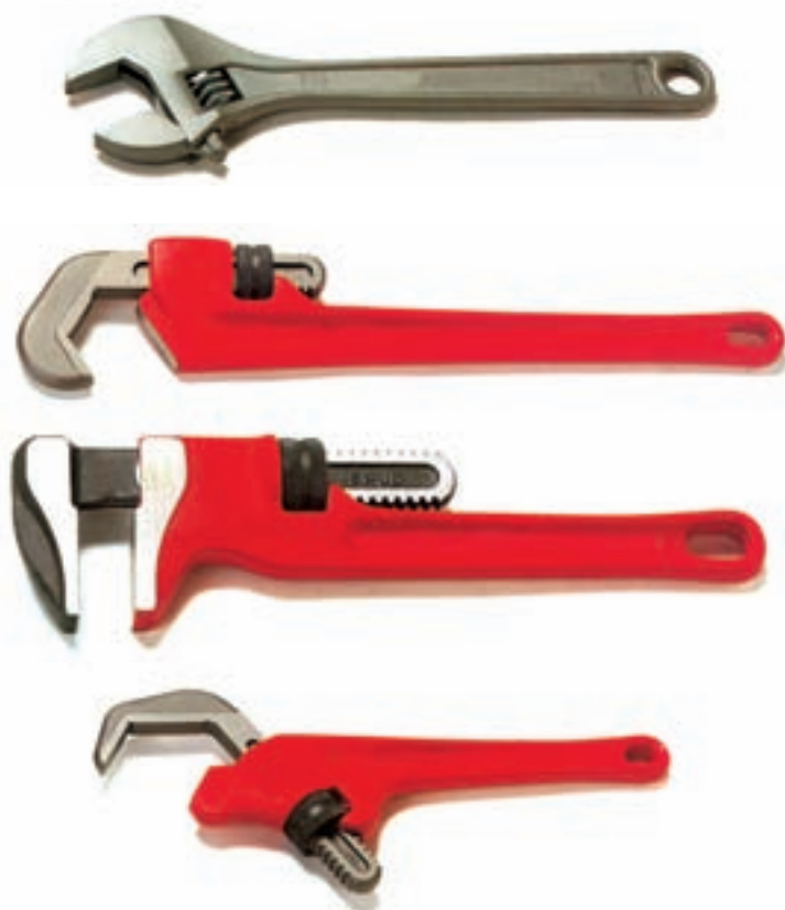
شکل ۱-۵۱- آچار فرانسه و چند ابزار دیگر جهت باز و بسته کردن مهره‌ها
