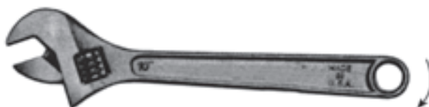
شکل ۱-۵۲- آچار فرانسه، توصیه می‌شود هنگام استفاده از این آچار همواره آنرا در جهت فلش بکشید.
