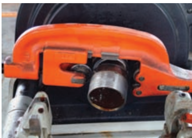
شکل ۱-۴۷- عمل بریدن لوله
