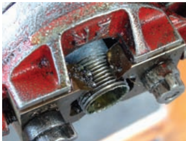
شکل ۱-۴۳ - پایان حدیده‌کاری با عبور دو دندانه از سر لوله
