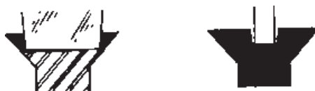
شکل ۱-۲۲- طرز قرار گرفتن صحیح نوک آچار از نظر طول و ضخامت در شیار
