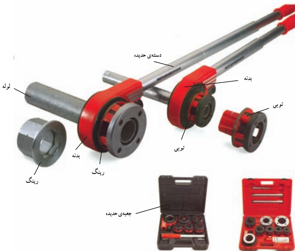
شکل ۳۶-۱- حدیده‌ی چهار بارچه‌ی غیر قابل تنظیم
