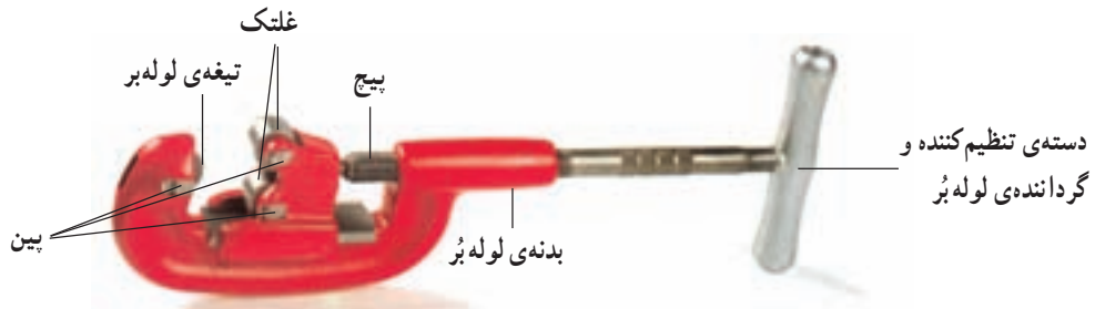
شکل ۱-۲۶- اجزای یک لوله بر فولادی
