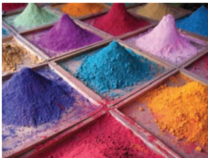
شکل ۳-۱۱- رنگینه‌های مورد استفاده در ساخت لعاب
