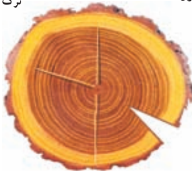
ترک تند باد (برق‌زدگی)
