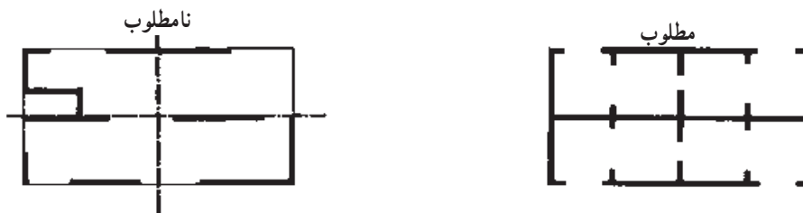
شکل ۵-۱۰ - نحوه‌ی قرارگیری دیوارها به طور منظم و متقارن در پلان ساختمان
