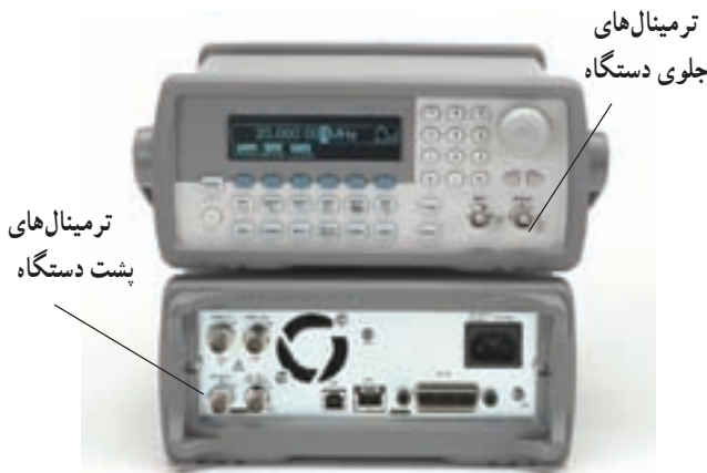
شکل ۱۷-۲- یک نمونه فانکشن ژنراتور مدرن با ترمینال‌های ورودی در جلو و پشت دستگاه
