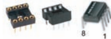
شکل ۹-۳۵- شکل ظاهری و سوکت آی‌سی NE ۵۵۵
