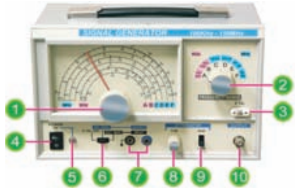
شکل ۱-۶- شکل ظاهری دستگاه مولد RF و کنترل‌های آن
