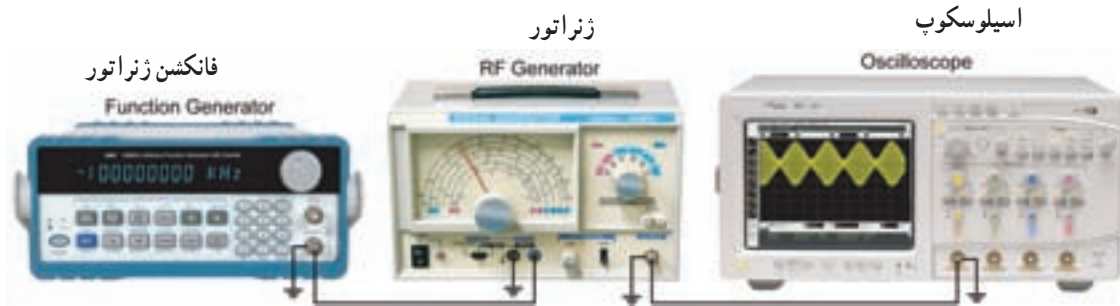
شکل ۶-۳ نحوه اتصال سیگنال ژنراتور RF برای مدولاسیون خارجی
