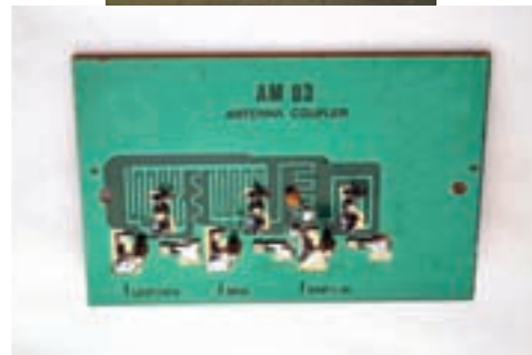
شکل ۴-۵- ترکیب کننده دو سیگنال و بُرد آن
