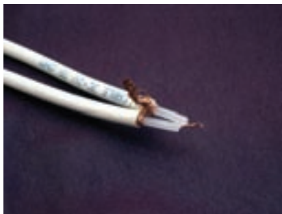
شکل ۱۶-۴ کابل نباید دو تکه باشد.
