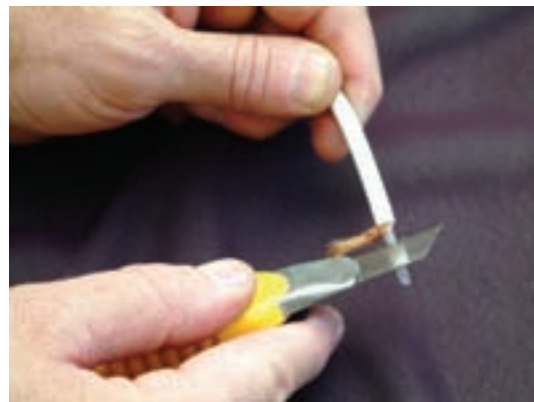
شکل ۱۴-۴ دقت کنید وسیله برنده به دست شما آسیب نرساند.
