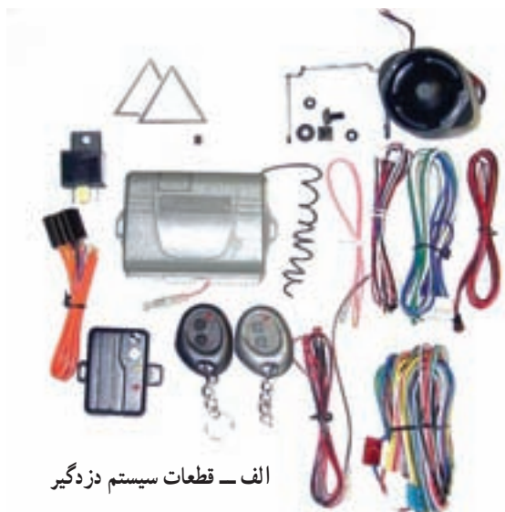
شکل ۳-۶-الف قطعات سیستم دزدگیر و دزدگیر به عنوان یک سیستم مخابراتی
