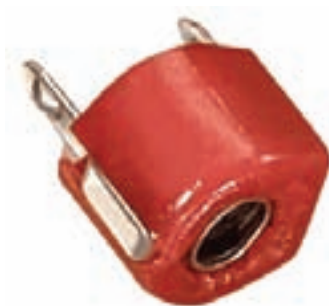
خازن‌های تریمر نصب شده روی خازن و اریابل
