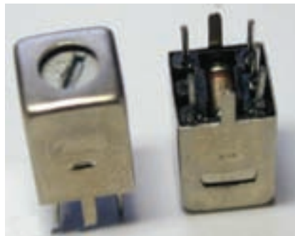
ترانس IF و خازن داخل آن
