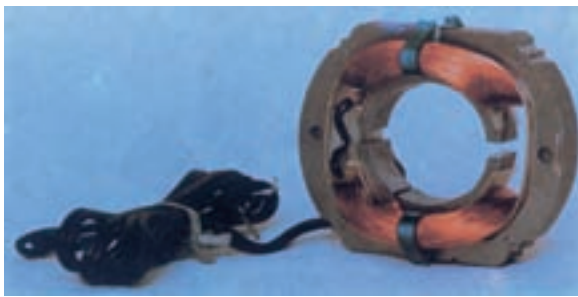
شکل ۸-۱۴ استاتور و هسته پمپ آب
