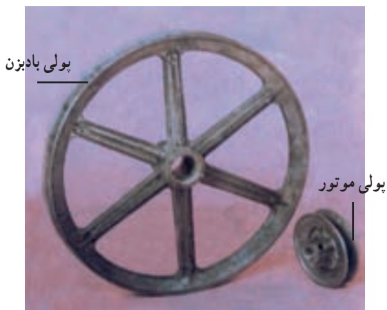
شکل ۸-۱۱ - پولی‌های موتور و فن
