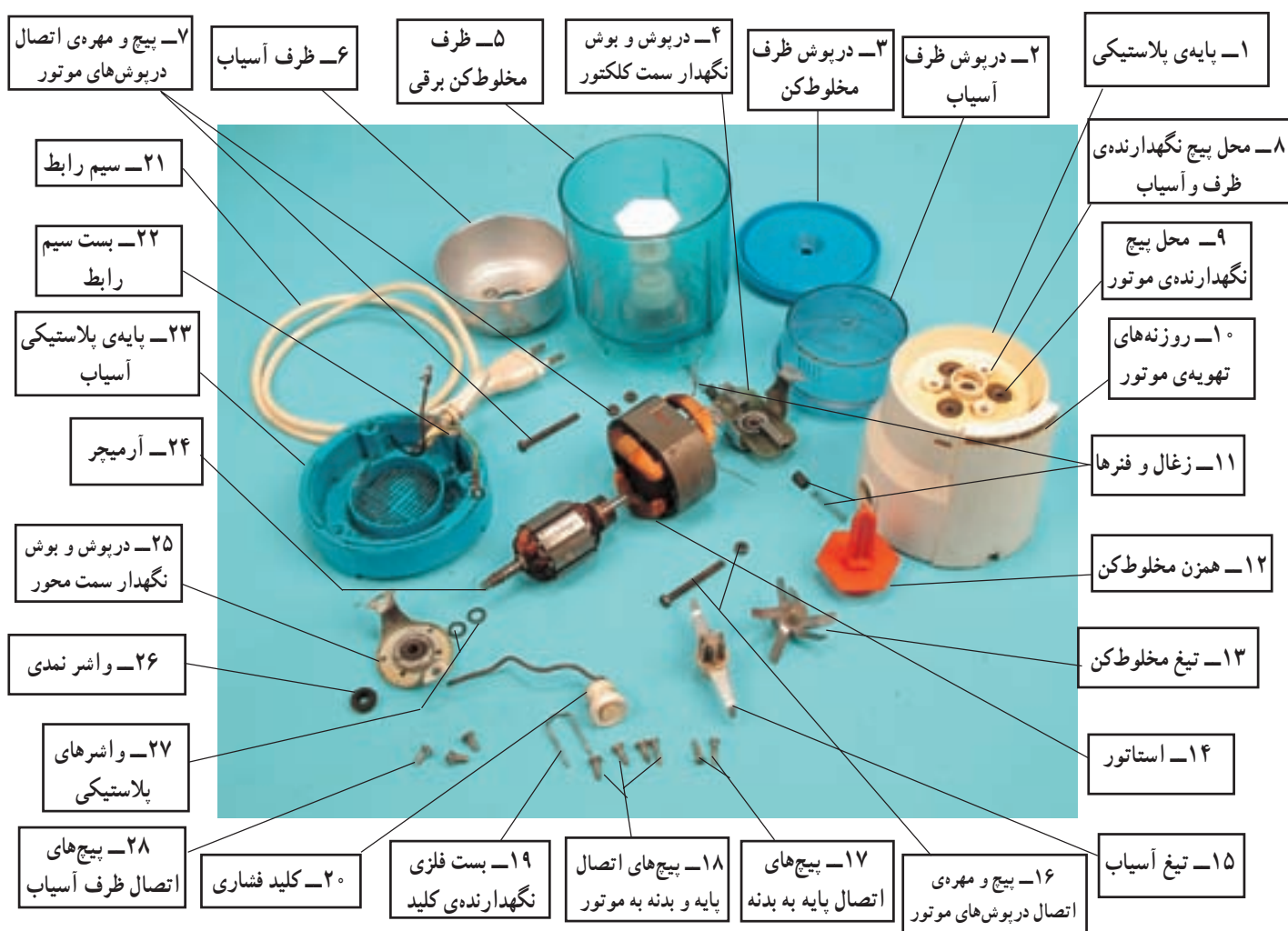
شکل ۴-۳۲- اجزای ساختمانی یک نمونه مخلوط‌کن برقی
