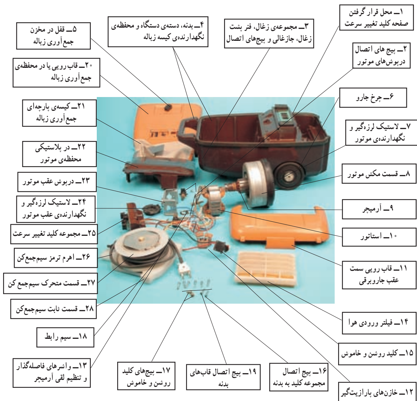
شکل ۲-۵۲ - اجزای ساختمانی یک نمونه جارو برقی
