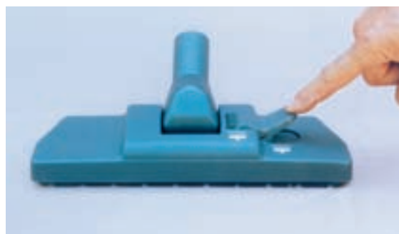
● اکثر برس‌های جاروبرقی دارای فرچه‌های مویی می‌باشد، با زدن اهرم روی برس، فرچه‌های مویی به داخل برس می‌رود و در این وضعیت برس روی قالی راحت حرکت می‌کند. اگر فرچه‌های مویی بیرون باشد برای حرکت روی موکت و موزاییک مناسب است (شکل ۸-۲).
