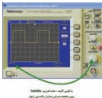
شکل ۶-۴۸ تغییر کلید Volt/Div و نمایش شکل موج
