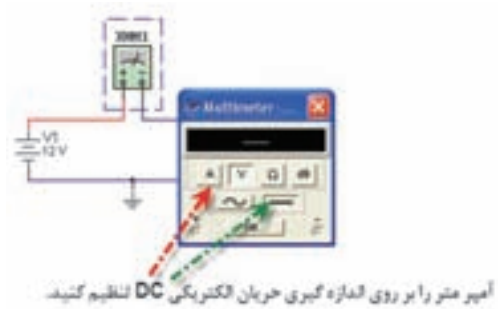
شکل ۶-۱۴ - تنظیم آمپر متر روی حالت DC
