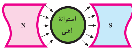
شکل ۳-۵- چگونگی ایجاد میدان مغناطیسی یکنواخت و شعاعی
