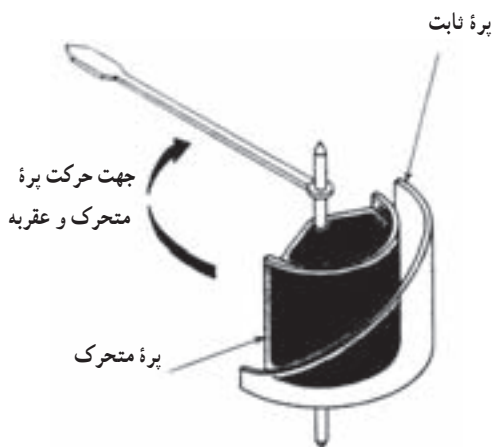
شکل ۳۰-۵- پره ثابت از یک شیب برخوردار است تا یک میدان غیر یکنواخت بین دو پره به وجود آورد.
