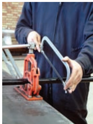
شکل ۱۷-۲- نحوه برش و پلیسه برداری لوله فولادی با استفاده از سوهان و انبردست
