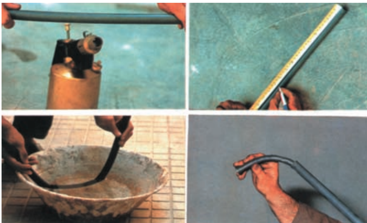
شکل ۲۲-۲- مراحل مختلف خم کردن لوله P.V.C با استفاده از چراغ کوره‌ای و شعله گاز
