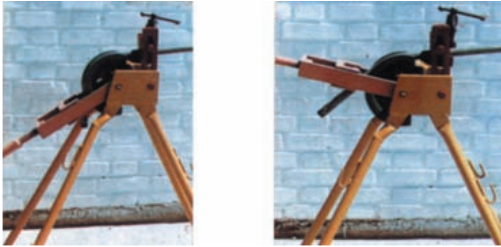
شکل ۱۹-۲- مراحل مختلف خم کردن لوله فولادی
