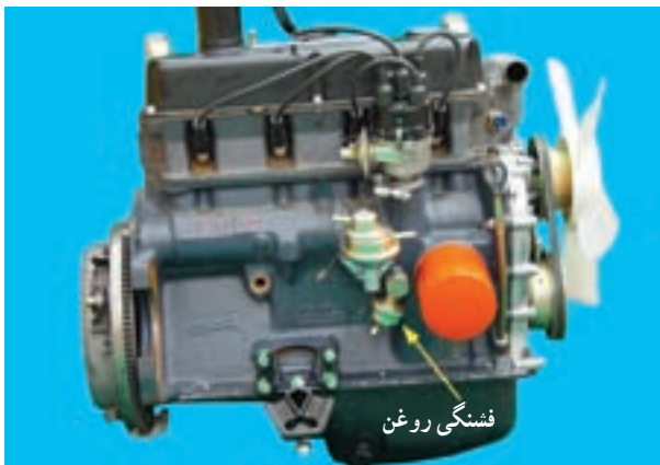
شکل ۱-۱۲- موتور اتومبیل و محل نصب شمع فشنگی یا سنسور روغن
