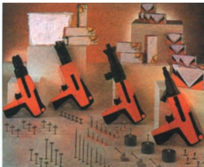
شکل ۲۰-۱- چند نمونه تفنگ و چاشنی و میخ و طرز کار آنها
