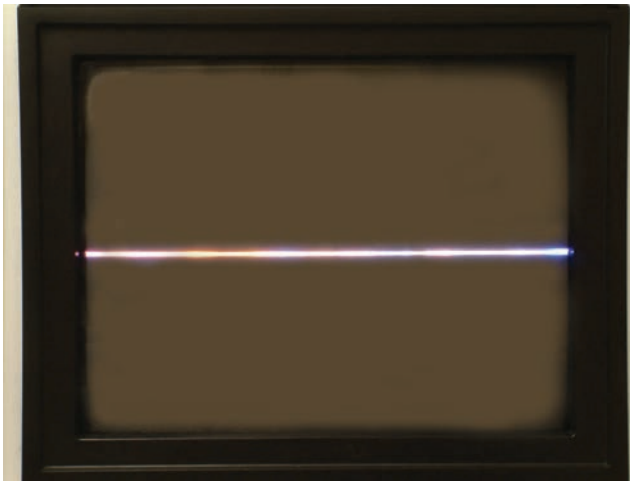
شکل ۲-۸۶- اسیلاتور عمودی از کار افتاده است.
