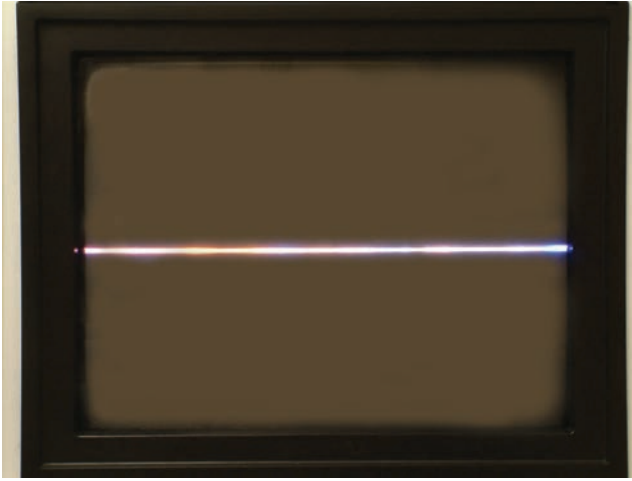
شکل ۲-۹۱- تغذیه آی سی تقویت خروجی عمودی وجود ندارد.
