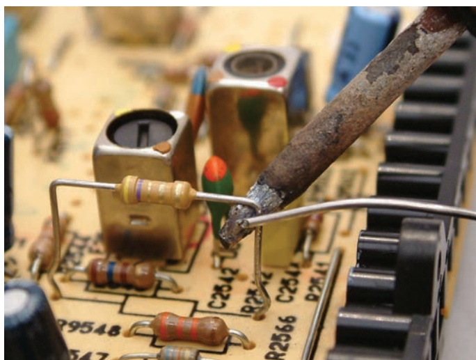
شکل ۳۰-۲- لحیم‌کاری مجدد پایه قطع شده قطعه پس از اتمام کار
