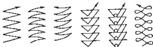
شکل ۳-۳۲- حالت‌های مختلف حرکت نوسانی نوک الکتروود
