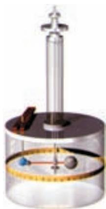
شکل ۱-۱۵- ترازوی پیچشی کولن
