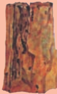
چوب خورده شده به وسیله‌ی موریانه‌ی خانگی
