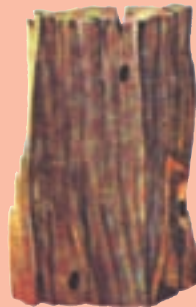
چوب خورده شده به وسیله‌ی موریانه‌ی خانگی
