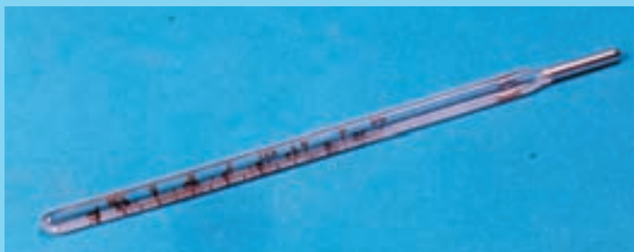
دماسنج جیوه‌ای پزشکی برای اندازه‌گیری دمای بدن
