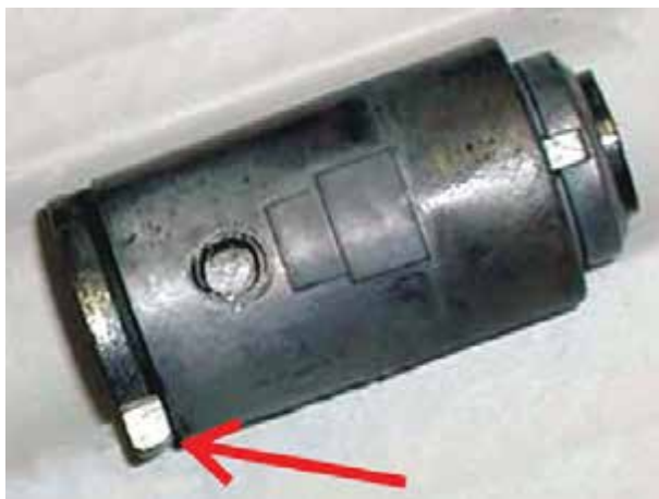
شکل ۱۹-۱۱- مغزی سوئیچ اصلی موتور
