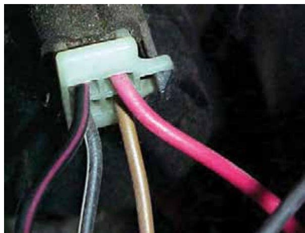
شکل ۸-۱۱- کد رنگ سیم های سوکت سوئیچ اصلی در یک نوع خودرو
