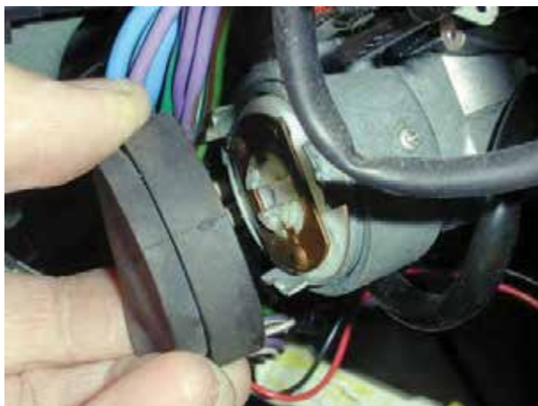
شکل ۱۱-۱۳- بیرون آوردن فیبری پشت سوئیچ
